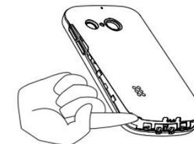
1. Retirez le couvercle du compartiment de la batterie à l'arrière de l'appareil
